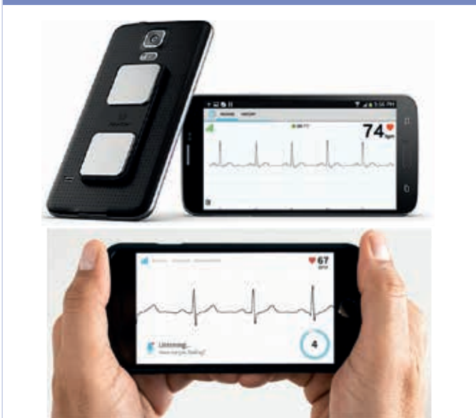
Figure 6 : Système AliveCor Kardia® développé par la firme américaine AliveCor, constitué d'un petit dispositif de capture d'ECG à 1 dérivation à partir des doigts, connecté à une application pour Smartphone permettant d'enregistrer 30 secondes d'ECG (iECG).
