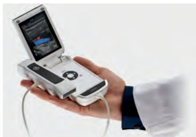
FIGURE N°1 : Exemple d’échographe portable : Le Vscan® commercialisé par General Electrics Healthcare
